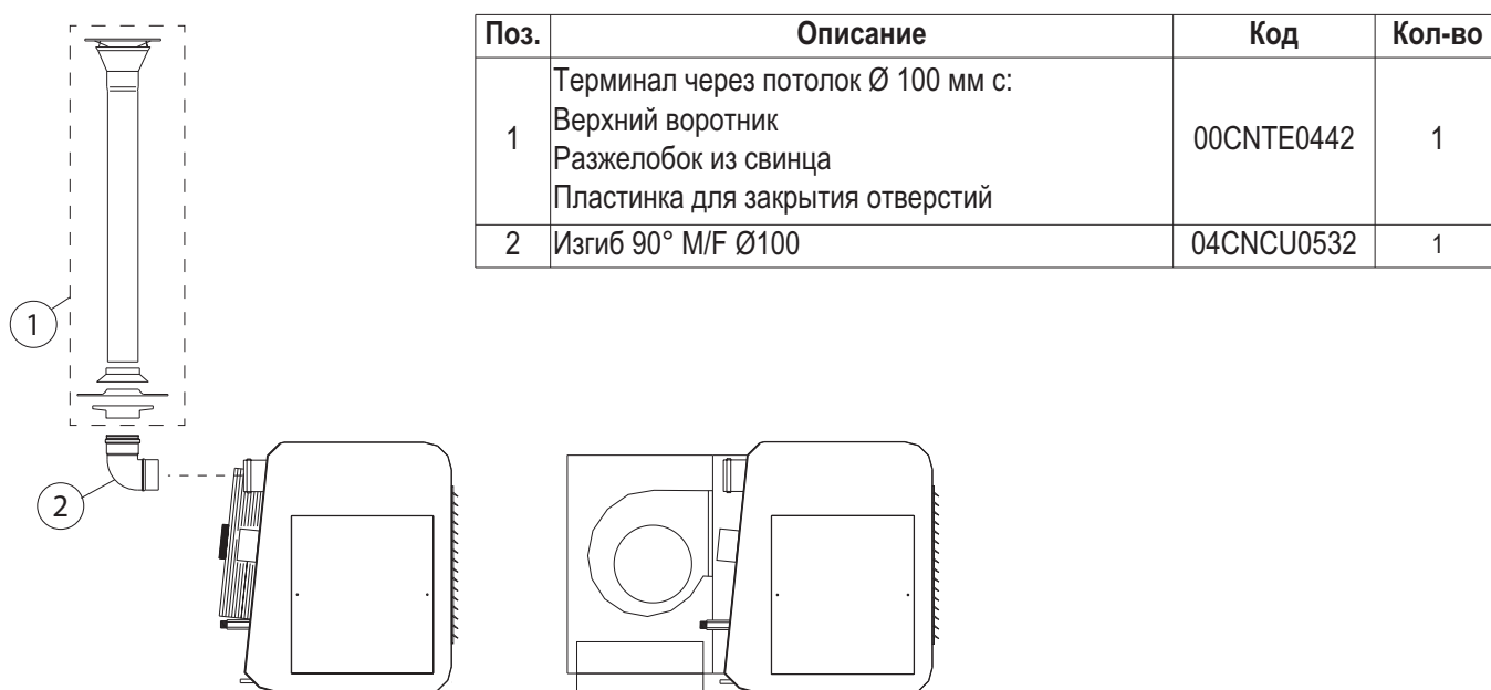
Рис. 5.4 Каналы дымоудаления типа В23 через потолок
